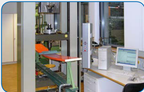
Festigkeitskontrolle für Gestelle, Schnäpper, Platten am Prüfinstitut in Rosenheim
